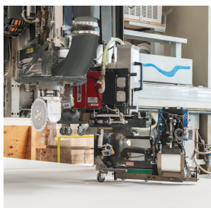
Klammebro til maskinel befæstigelse.
