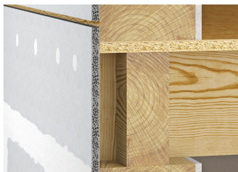
figur 1: Pladestrimmel med korrekt påført armeringsbånd og -klæber.
