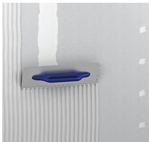
figur 1: Påføring af grundpuds med 12 mm tandspartel.
